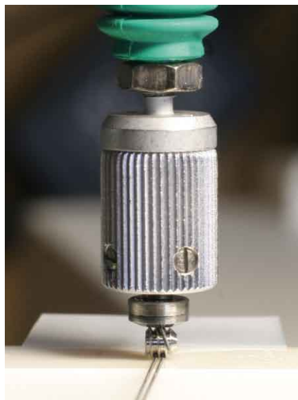
Mesure de diamants sur flancs.
